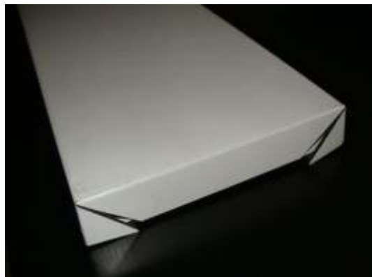
Tvarovka Dibond – čelní pohled po nařezování a ohybu
