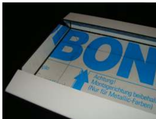
Tvarovka Dibond – zadní pohled po nařezování a ohybu
